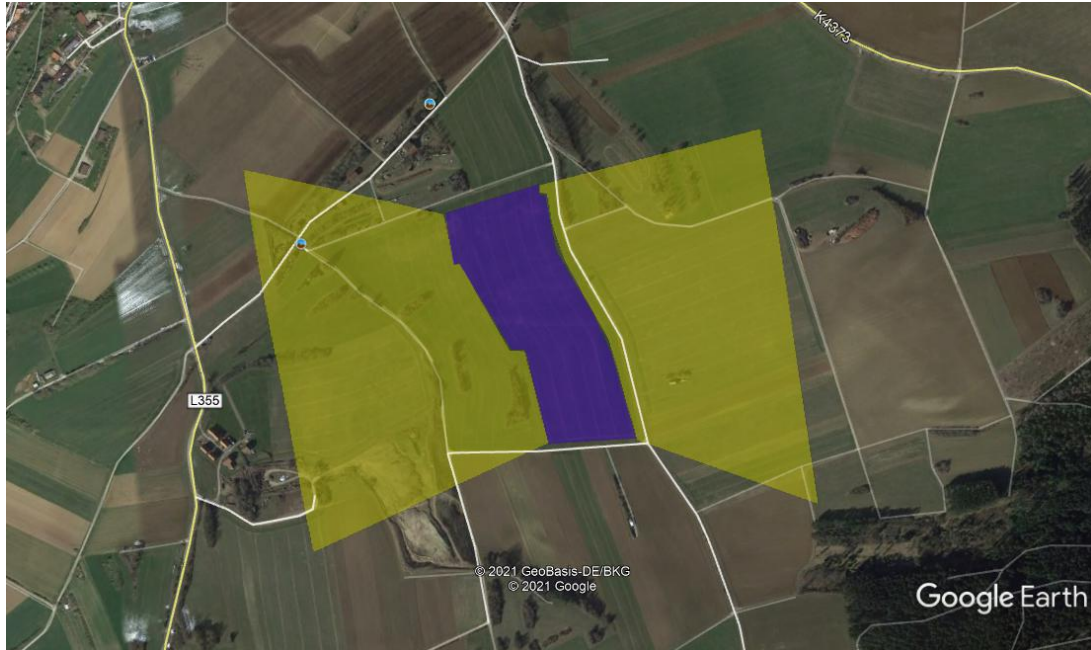
Abb. 8: PV-Anlage Haiterbach Blätschenschneider (blau) mit den möglichen Reflexionsbereichen auf der Ebene (gelb)
